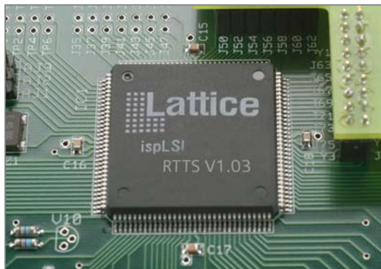
Das System basiert auf der FPG-Steuerkarte BMS 100, hochgenaue Geschwindigkeitsmessung mit 40 MHz Auflösung,
